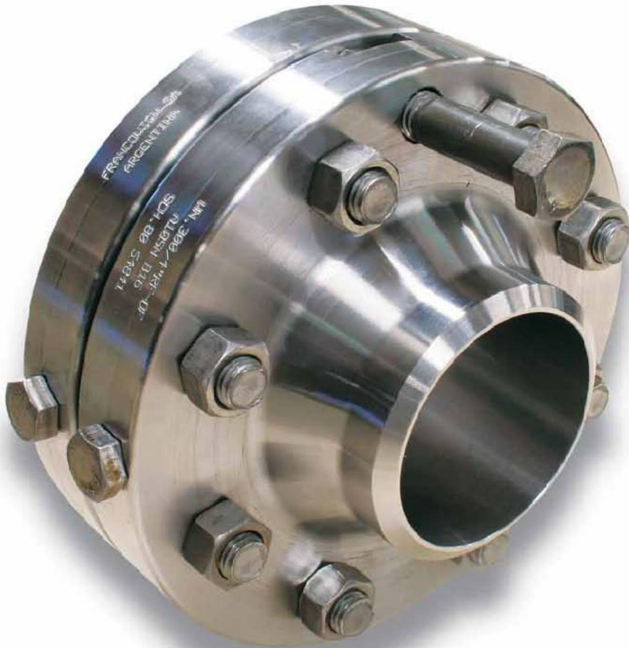
Las bridas de orificio se utilizan para medir caudales en líquidos o gases. El principio se basa en la caída de presión que produce el flujo al pasar por un agujero calibrado.
