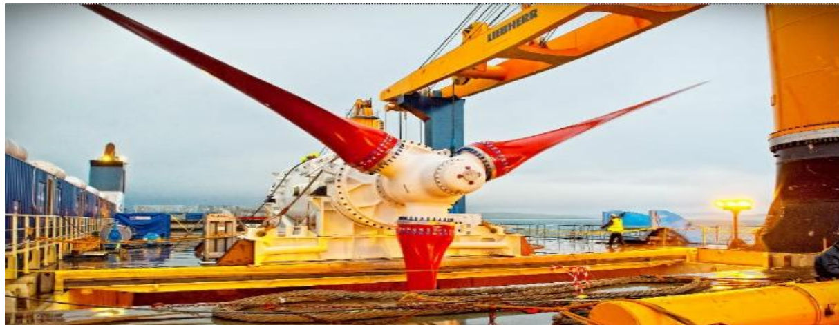
Turbina de 1MW (21 metros de diámetro)
