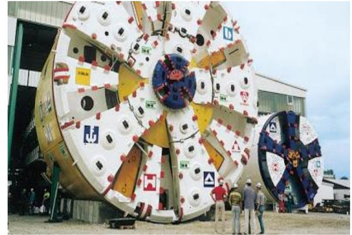
Tuneladoras con escudos ofrecen un alto grado de flexibilidad: son capaces de excavar a través de cualquier roca y en condiciones de suelos cambiantes, también bajo nivel freático y a cualquier profundidad.
