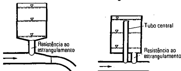
Figura 6.201 Tipos de chaminés de equilíbrio com estrangulamento
