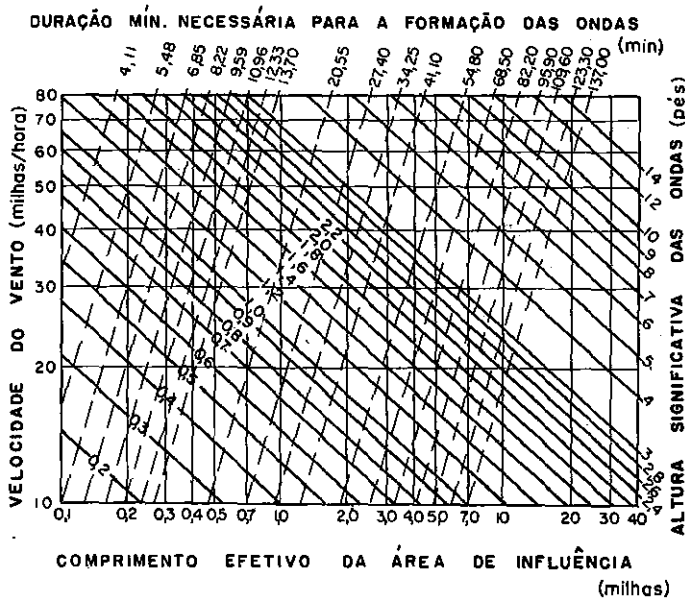
Figura 6.12 Altura significativa das ondas indicando a duração mínima para sua formação
