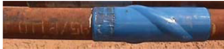
Figura 1, Centralización de los tubulares.
