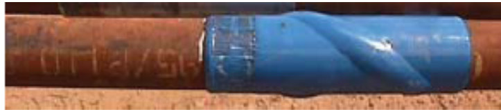
Figura 1, Centralización de los tubulares.
