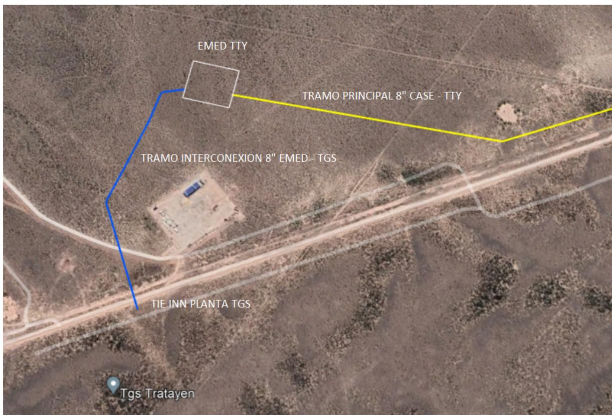
**Figura 2.** Ducto Interconexión TTY - TGS
