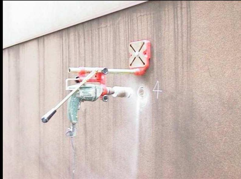
**ABNT NBR 13528:2010** Determinación de adherencia a
