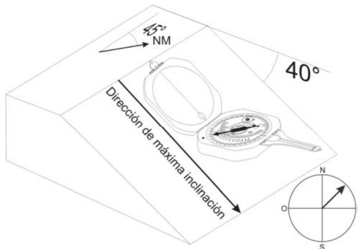
Al medir el **buzamiento** debemos tener el recaudo que la brújula, abierta y apoyada totalmente sobre uno de sus cantos (es decir en posición vertical), esté colocada en la dirección de máxima inclinación, es decir perpendicular al rumbo. Una vez centrada la burbuja del nivel tubular, podremos leer en la escala semi circular (o escala del clinómetro) el ángulo que indica el clinómetro; ese ángulo será el buzamiento.
