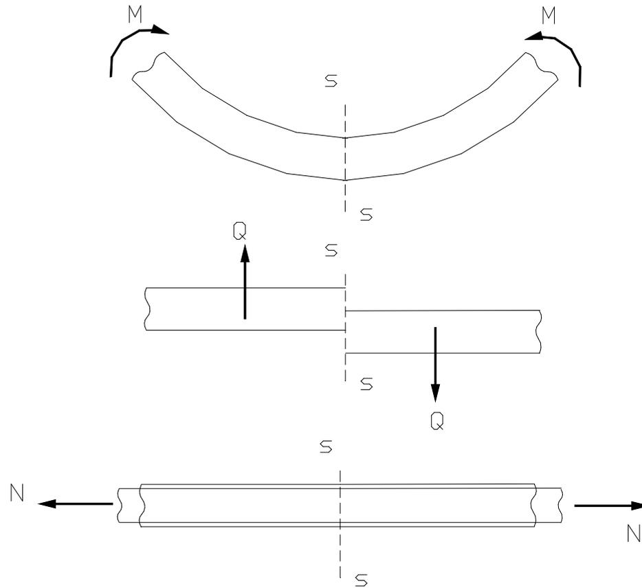
**El esfuerzo cortante en una sección s-s de la viga se considera positivo si la proyección sobre su plano de la resultante de las fuerzas exteriores actuantes a la izquierda de la sección, está dirigida hacia arriba (y la de las fuerzas de la derecha hacia abajo).- En caso contrario el esfuerzo de corte se considera negativo.**
