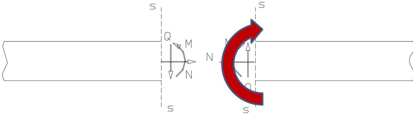
**El momento flector  $M$  es una componente de la resultante de las fuerzas internas que se desarrollan en la sección, y se calcula sumando algebraicamente los momentos, respecto al baricentro de la sección, de todas las fuerzas exteriores que actúan a uno u otro lado de la sección considerada.**
