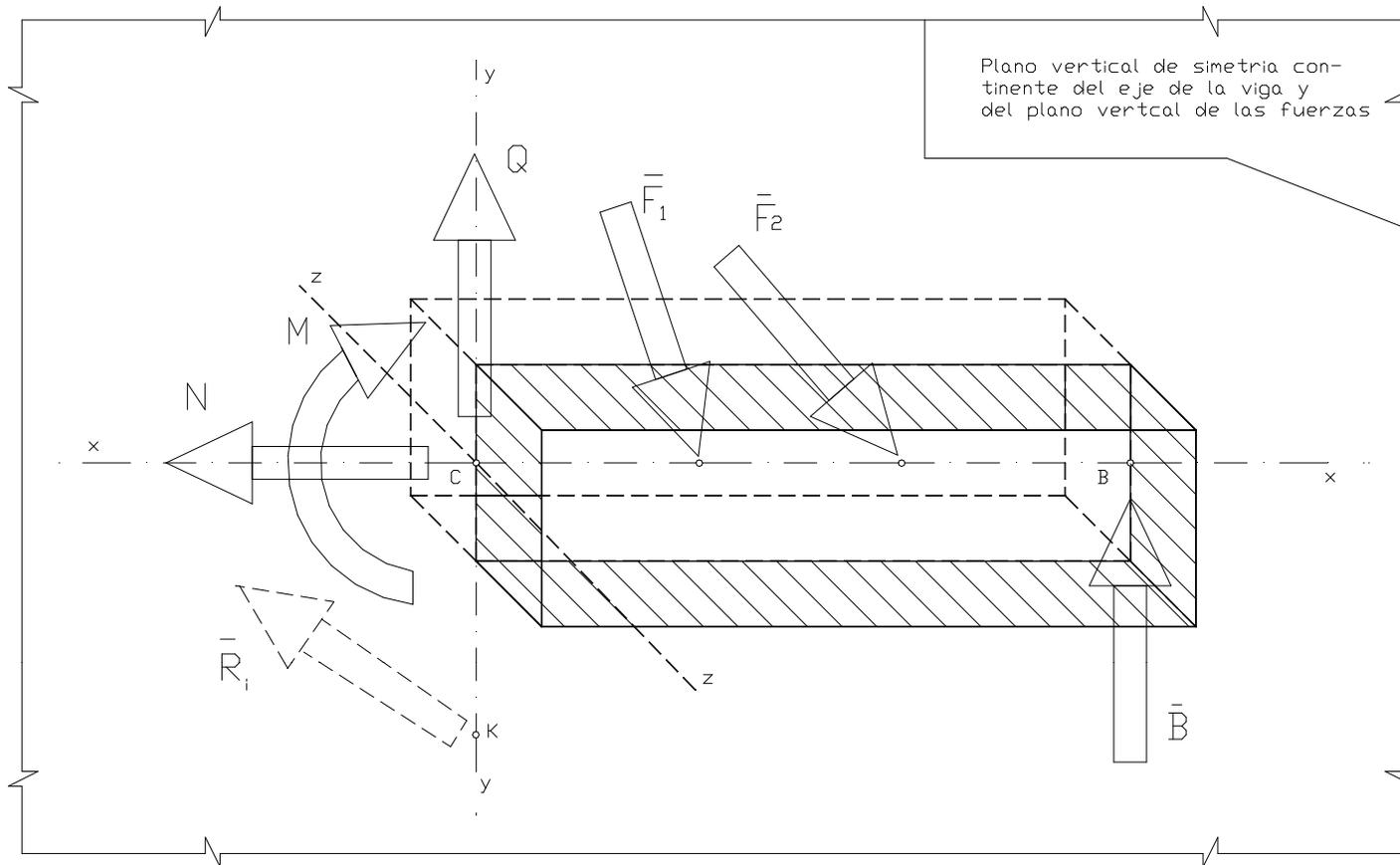
**Las tres componentes de la reacción interna  $M$  ,  $Q$  ,  $N$  , expresadas cada una de ellas por dos elementos iguales y opuestos según se considere la cara izquierda o derecha del corte, se denominan **esfuerzos internos o característicos en la sección transversal considerada.****
