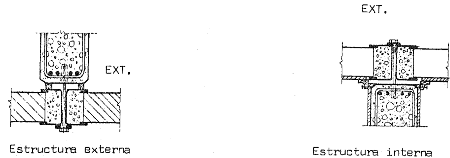
c) Encuentros de muros excentos con columnas
