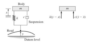
desplazamiento de la superficie de la carretera y (t) puede derivarse del perfil de la superficie de la carretera y la velocidad del automóvil. Encuentre la ecuación de movimiento de m con y(t) como entrada, y obtenga la función de transferencia.
