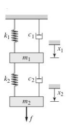
7) El modelo de la suspensión de un vehículo se muestra en la figura. En este modelo simplificado, las masas de la rueda, el neumático y el eje no se consideran. La masa m representa uno cuarto de la masa del vehículo. La constante de resorte k modela la elasticidad tanto del neumático como del muelle de suspensión. La constante de amortiguación c modela el amortiguador. La posición de equilibrio de m es cuando y = 0 y x = 0. El
