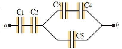
$$U_4 = 9,72 \text{ nJ} = \frac{1}{2} \cdot \frac{Q_4^2}{C_4} \rightarrow Q_4 = 10,8 \text{ nC} = Q_3 \rightarrow \frac{Q_4}{C_4} + \frac{Q_3}{C_3} = \frac{Q_5}{C_5} \rightarrow Q_5 = 7,2 \text{ nC}$$
