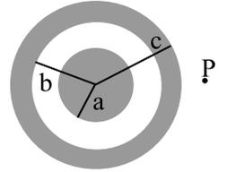
$$E \cdot 4\pi r^2 = \frac{q_{\text{Cascarón}} + q_{\text{Esfera}}}{\epsilon_0} \Rightarrow q_{\text{Esfera}} = 28 \cdot 10^3 \text{ N/C} \cdot 4\pi (0,08 \text{ m})^2 \cdot \epsilon_0 - 30 \cdot 10^{-9} \text{ C} = -10,1 \text{ nC}$$
