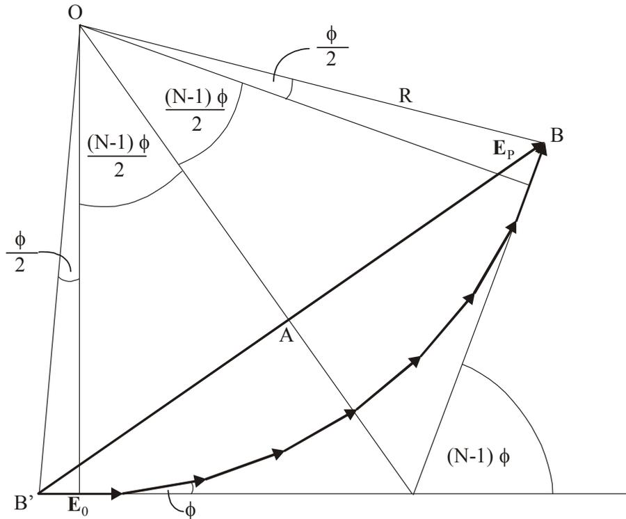
Lo que pretendemos obtener es la amplitud del campo eléctrico  $E_p$  resultante en un punto P genérico sobre una pantalla para un sistema de N ranuras. El diagrama muestra el caso particular para  $N = 8$  ranuras, pero el análisis es general y válido para cualquier número N (de allí que en la notación de los ángulos se use N y no 8).
