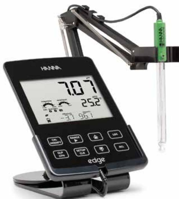
**Figura 10.** Medidor de pH y conductividad eléctrica de sobremesa disponible en Laboratorio de Química General para estudiantes.
