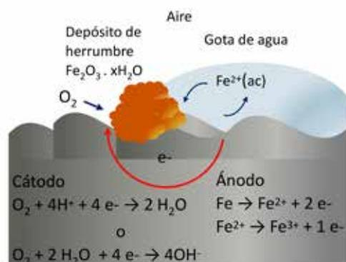
El mecanismo electroquímico de la corrosión permite explicar por qué las chapas de los automóviles se oxidan con mayor facilidad en los climas marítimos que en los mediterráneos.
