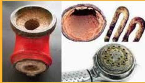
**Figura 17.** Depósito de carbonato de calcio proveniente de aguas duras.
