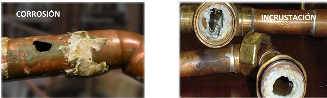
Figura 6. Ejemplos de corrosión
