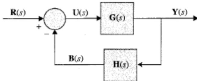
**Figura 3-6** Diagrama de bloques de un sistema de control realimentado multivariable.
