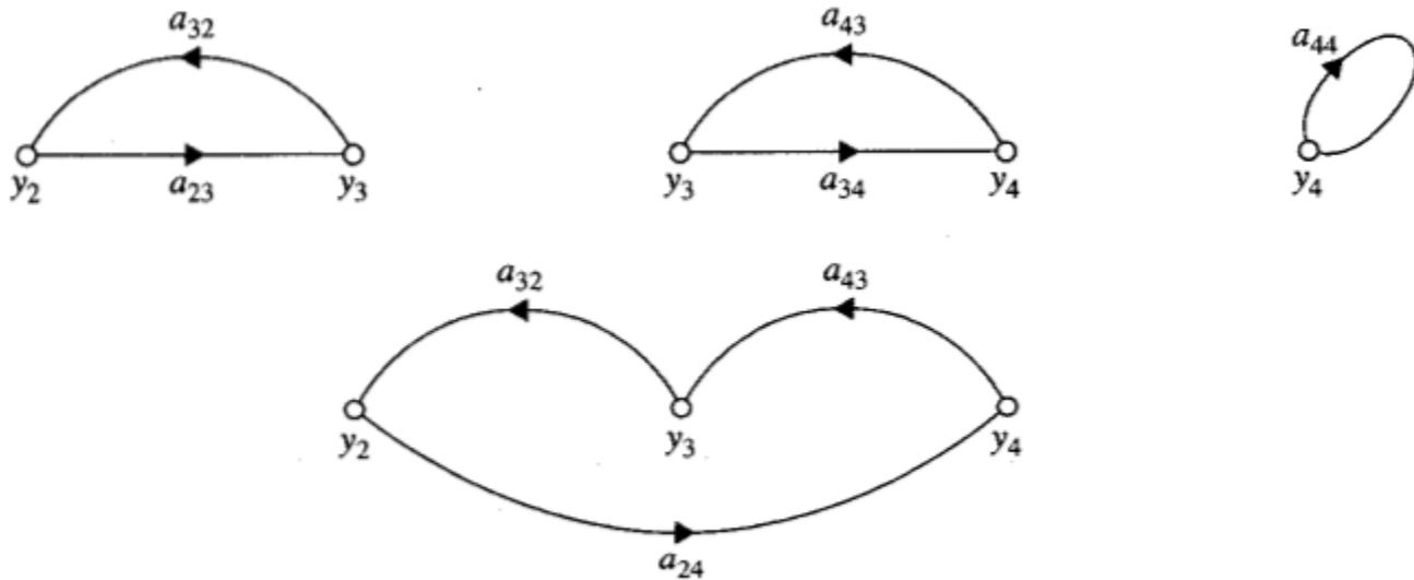
**Figura 3-11** Cuatro mallas en la gráfica de flujo de señal de la Fig. 3-8(d).
