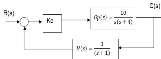
6. En base al arreglo de Routh, determinar cuál es el intervalo de valores de Kc (ganancia del controlador proporcional) dentro del cual el sistema es estable. Aplicar Método de Sustitución Directa para corroborar los valores obtenidos
