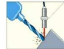
Detección de ruptura de puntas de fresadora
