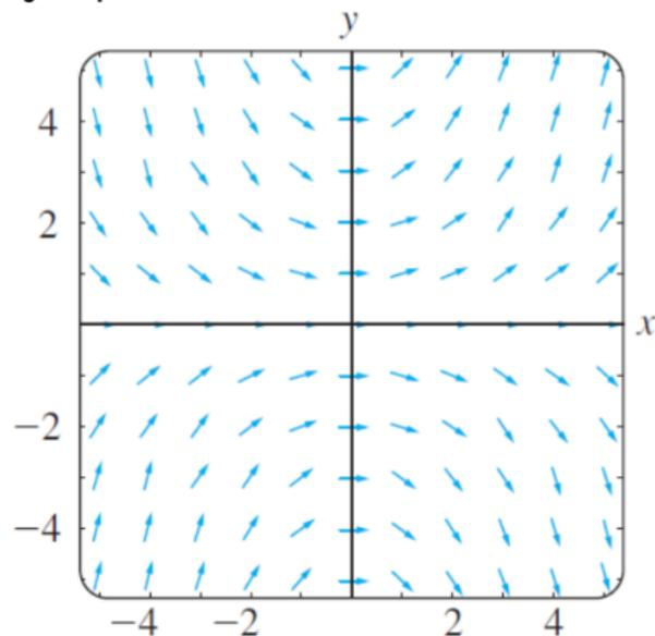
**a)** Campo direccional para  $dy/dx = 0.2xy$ .
