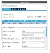
Al seleccionar GPIO Output, aparecen las opciones de configuración, para elegir estado inicial (*GPIO Output Level*), Modo (*Push-Pull, Open Drain*), velocidad, e incluso ponerle un rótulo. Este rótulo servirá luego para usar las funciones de escritura del pin sin especificar puerto o número de pin, haciendo el código más claro y portable.
