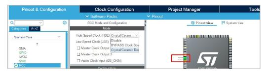
En la categoría *System Core\RCC*, escoger el clock de sistema. Si se utilizará clock interno dejar en estado *Disable*. Tanto la *discovery* como la *bluepill* tienen un cristal de 8MHz como reloj principal HSE (*high speed external*). Si se lo quiere utilizar debe seleccionarse la opción *Crystal/Ceramic Resonator*. Esta opción utiliza dos pines (*RCC\_OSC\_IN* y *RCC\_OSC\_OUT*).
