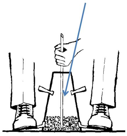
Llenar el Cono en tres capas: Llénese hasta aproximadamente 1/3 de su volumen y compactar el hormigón con una barra de acero de 16 mm de diámetro terminada en una punta cónica rematada por un casquete esférico La compactación se hace con 25 golpes de la varilla, con el extremo semiesférico impactando al hormigón.
