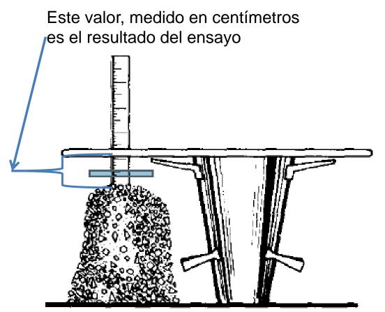
A continuación se coloca el Cono de Abrams al lado del formado por el hormigón y se mide la diferencia de altura entre ambos. Si la superficie del cono de hormigón no queda horizontal, debe medirse en un punto medio de la altura y nunca en el más bajo o en el más alto . Este valor de la diferencia de alturas, medido en centímetros, es el resultado del Ensayo de cono de Abrams y se denomina asentamiento del hormigón
