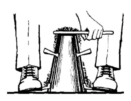
Retirar el exceso del hormigón con una llana metálica, de modo que el Cono quede perfectamente lleno y enrasado. Quitar el hormigón que pueda haber caído alrededor de la base del Cono.
