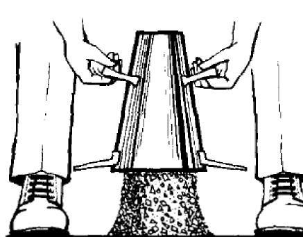
Sacar el molde con cuidado, levantándolo verticalmente en un movimiento continuo, sin golpes ni vibraciones y sin movimientos laterales o de torsión que puedan modificar la posición del hormigón
