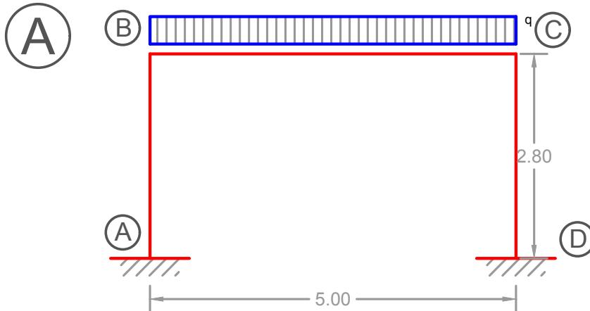
Partiremos de una sección para viga sabemos que  $\frac{L}{15} = 0,33\text{cm}$  por lo que adoptaremos  $h=35\text{cm}$  y de base tomaremos  $b=25\text{cm}$ . Para las columnas tomaremos la siguiente sección  $h=35\text{cm}$  y  $b=25\text{cm}$ .
