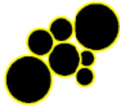
Floculación: El acercamiento de las gotas de asfalto produce que se adhieran
