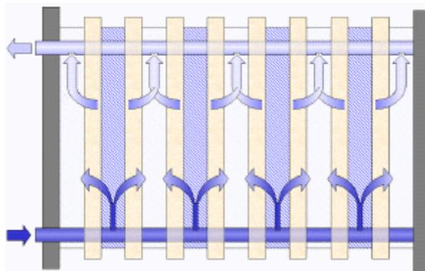
Las placas y los marcos contienen aberturas en un ángulo, las cuales forman un canal al cerrar el filtro y por donde se introduce la papilla de alimentación. Al circular la suspensión, la torta se forma en el lado más alejado de la placa, entrando por el marco, pasando el filtrado a través del medio y por la superficie acanalada de las placas del filtro y saliendo por un canal de salida en cada placa.
