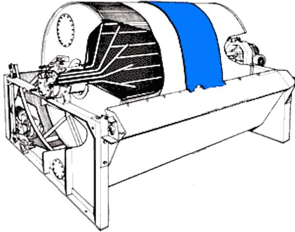
Para esta filtración se utiliza un término  $f$  que es la fracción del área total que se encuentra sumergida y del término  $t_c$  (tiempo de ciclo) que es el tiempo que dura el filtro en dar una sola vuelta.
