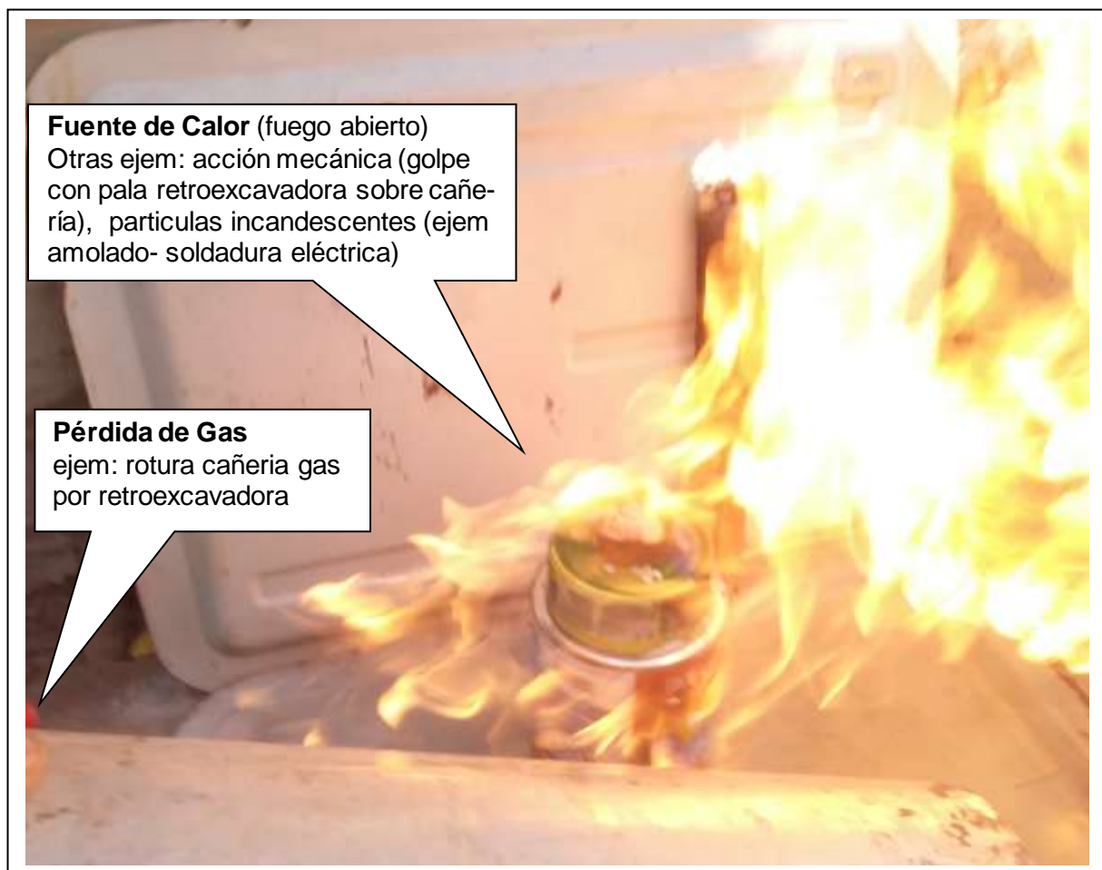
Fig Deflagración ( ejem aprox: Pérdida de gas + fuente de calor)
