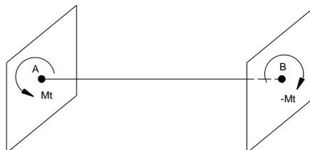
Cortando la pieza con un plano normal a su eje y admitiendo que su sección transversal sea circular.
