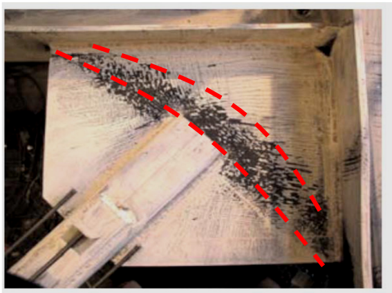
Fig. 5-46. Chapa nodal con patrón de fluencia de trayectoria elíptica ( Lehman et al., 2008 ).
