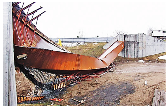
Fig. 1-13. Viga de un puente que ha fallado por pandeo lateral torsional durante la construcción ( https://civildigital.com/ )
