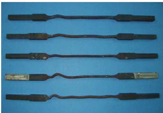
Fig. 7-9. Vista del núcleo de acero de riostras de pandeo restringido ensayadas por Palazzo et al. (2009) .
