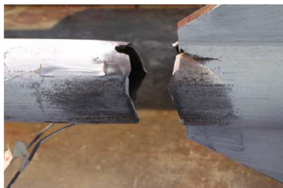
Fig. 5-39. Fractura de una riostra en la sección neta ( Fu et al., 2007 )
