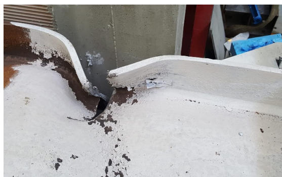
Fig. 1-9. Detalle de la fractura en el ala de una viga sometida a ensayos cíclicos en rango plástico.
