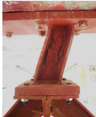
Fig. 6-23. Imagen de un enlace vertical ensayado por Mazzolani (2008) .
