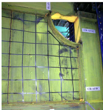
Fig. 8.7. Detalle de la perforación de esquina en un muro de corte con placas de acero ensayado por Vian y Bruneau (2004).
