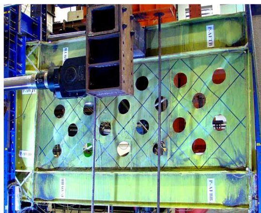
Fig. 8.5. Muro de corte con placas de acero y perforaciones de esquina ( Vian y Bruneau, 2004 )
