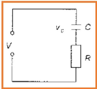
La razón de cambio de la diferencia de potencial  $v_c$  a través del capacitor con el tiempo es proporcional a la diferencia en valor entre  $v_c$  y el voltaje de entrada al sistema  $V$ .
