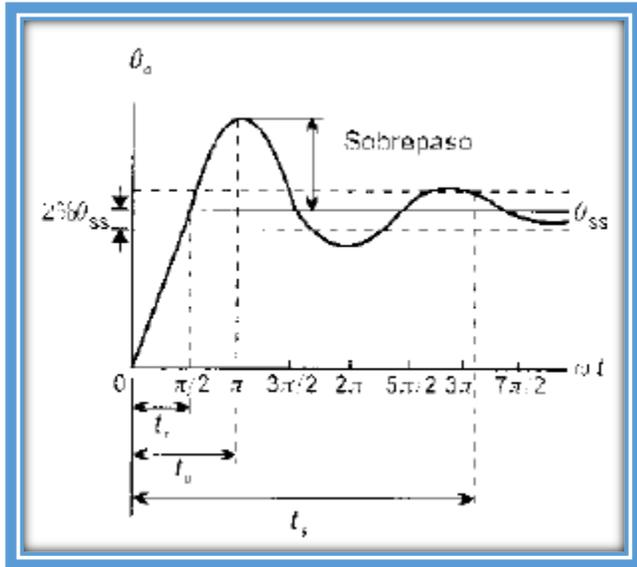
La figura ilustra la forma típica de la respuesta de un sistema sub-amortiguado a una entrada escalón. Se emplean algunos términos para especificar tal desempeño:
