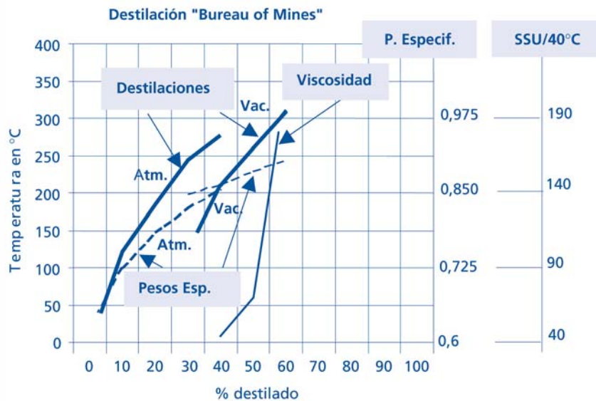
Fig. 17- Curvas de peso específico, temperatura de corte y viscosidad, del fraccionamiento del "Bureau of Mines" (TABLA 7).
