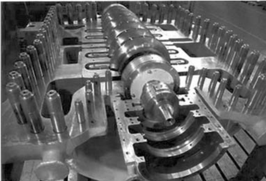
FIGURA 8.14 Interior de un compresor centrífugo (MAN Turbomachinery Inc. Estados Unidos).
