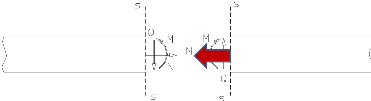
***El esfuerzo normal  $N$  es una componente de la resultante de las fuerzas internas que se desarrollan en la sección, y se calcula sumando algebraicamente las proyecciones sobre la normal al plano de la sección, de las fuerzas exteriores que actúan a uno u otro lado de la sección considerada.***
