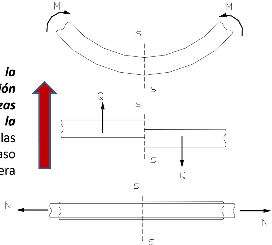
**El esfuerzo axial en una sección s-s de la viga se considera positivo si las fuerzas exteriores que actúan a uno u otro lado de la sección tienden a alargar la viga traccionándola, en cambio es negativo si las fibras son comprimidas.**
