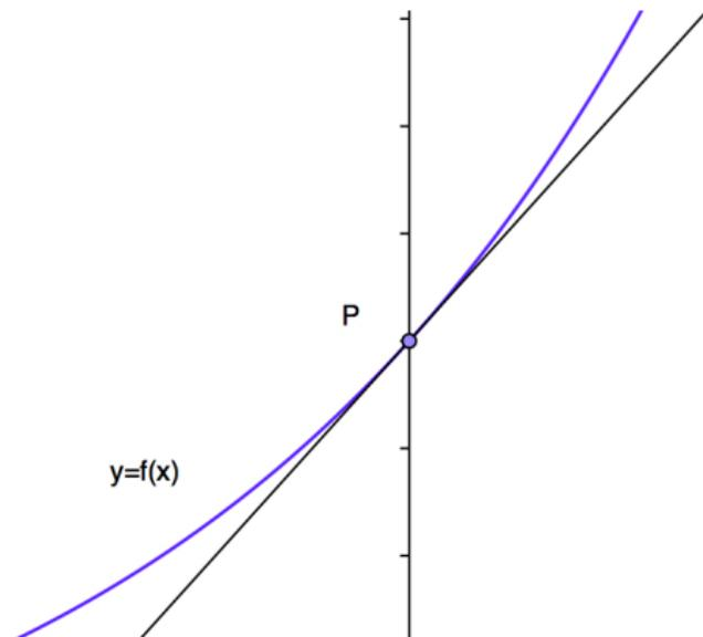
Así, cerca del punto de tangencia, las gráficas de la función y de la recta tangente se vuelven indistinguibles. Esto implica que es posible utilizar la ecuación de la recta tangente para obtener buenas aproximaciones de la función  $f$ .
