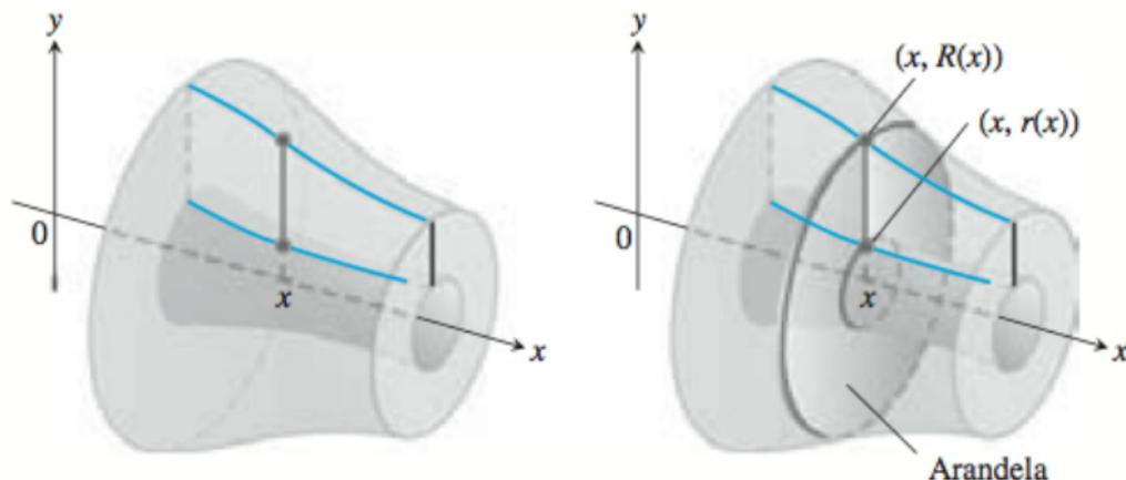
Observar que tenemos un radio mayor  $R(x)$  y uno menor  $r(x)$ . El área  $A(x)$  de las secciones transversales es:
