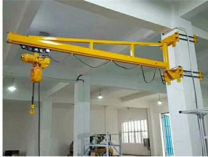
Figura 7: Viga en voladizo
