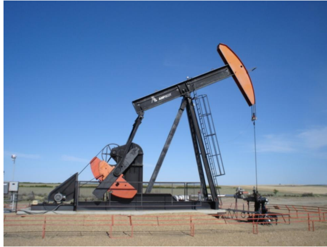
Figura 16: Equipo de bombeo de petróleo
