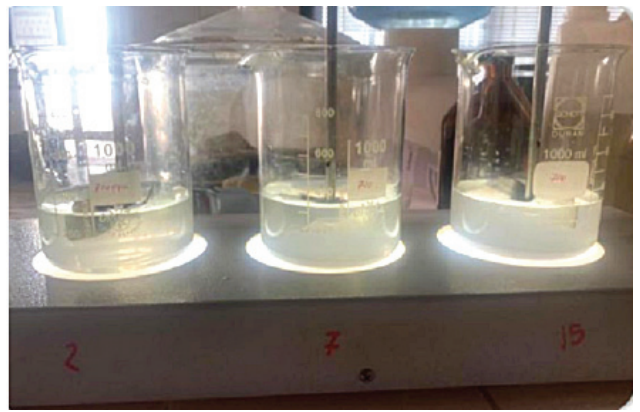
Figura 25. Jar test de productos químicos Puesta en Marcha de Plantas Inyectoras de Polímeros (PIU).
