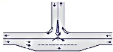
FORMA BÁSICA DE ENCUENTRO DE 3 RAMAS CON ELEVADO VOLUMEN QUE REALIZAN GIROS
