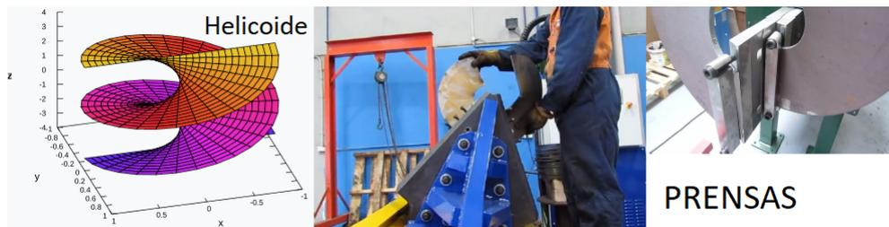
Para construir este tipo de piezas, puede por ejemplo, utilizarse prensas o unirse porciones de material. En las imágenes de la derecha, se corta una corona circular y se la **dobla**, usando una prensa, para obtener la forma deseada. Acá entran en juego características del material, que permite hacer esto sin romperse o deformarse de maneras no deseadas. La siguiente ecuación corresponde a una hélice, definida para valores de  $t$  en un intervalo  $[a, b]$ :
