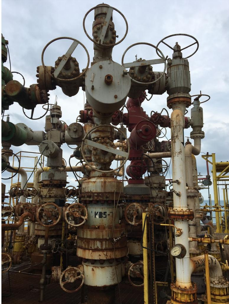
Los Pozos Petroleros conocidos como medios árboles de producción, se componen de un conjunto de válvulas y equipos de seguridad que permiten el flujo de los hidrocarburos a superficie.
