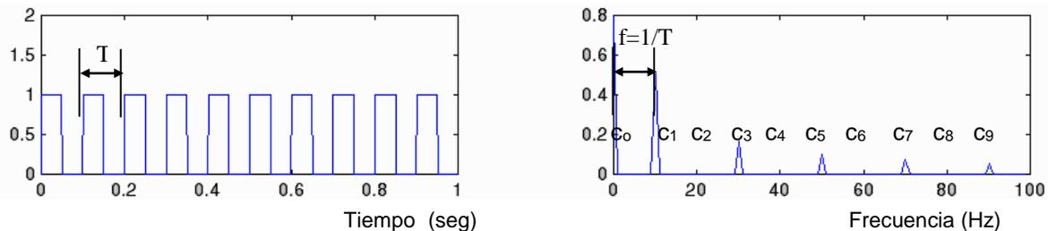
Este espectro es teóricamente infinito (ancho de banda infinito). Las señales reales ocupan un ancho de banda finito. Por ejemplo una señal de audio ocupa un rango de frecuencias entre unos 20Hz y 15 kHz.
