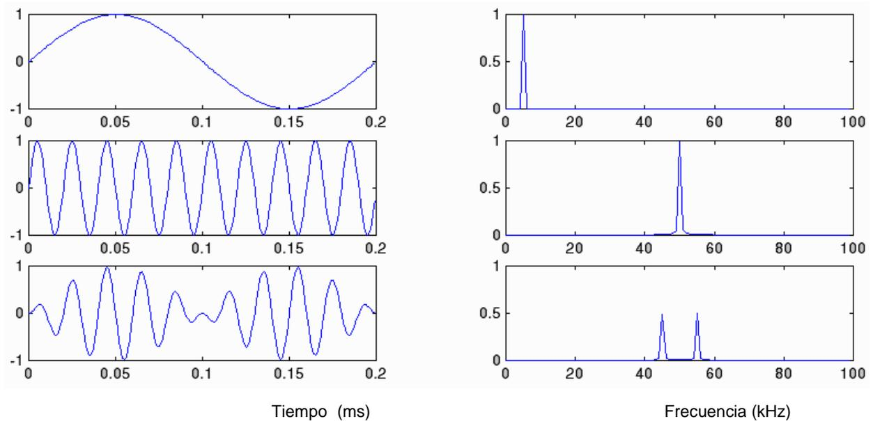
Al muestrear la señal analógica  $s(t)$  obtenemos una señal  $s^*(t)$  que equivale al producto de la señal original por la función impulso repetitivo  $dr(t)$
