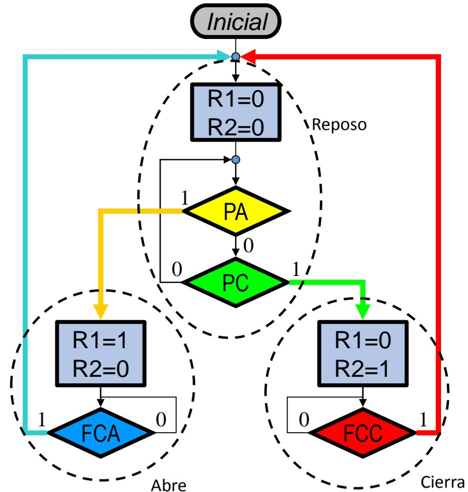
En el Diagrama de Estado (izquierda) se ha coloreado las flechas de las transiciones, que son justamente condiciones o eventos que producen el “salto” de un estado a otro, y se puede observar en el diagrama de flujo (derecha) que estas condiciones corresponden a las bifurcaciones o saltos condicionales (rombos) del diagrama de flujo.
