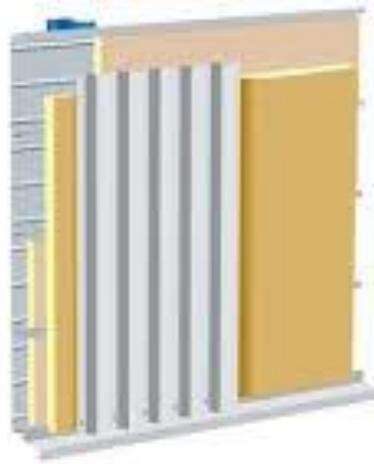
El cierre metálico lo conformamos con la chapa elegida, con o sin espuma de poliuretano.
