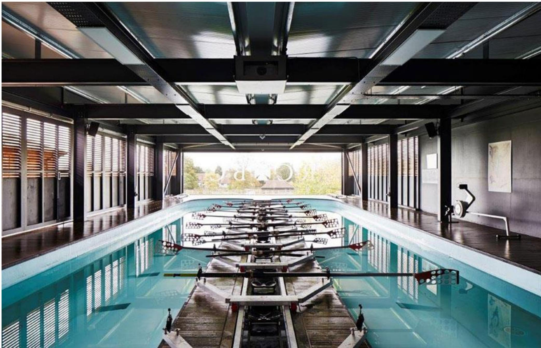
Para reproducir la experiencia real de remo de forma más fiel, el tanque no tiene calefacción ni energía, y la resistencia la proporciona el agua que fluye en un circuito de doble retorno alrededor y debajo del bote", dijo el estudio.
