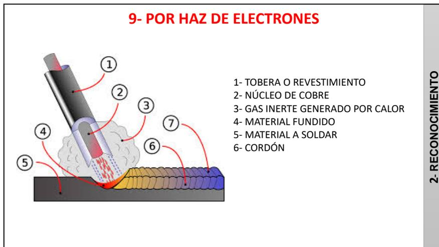
La **soldadura por haz de electrones** es un proceso de soldadura de fusión, que se logra mediante el contacto de la pieza a soldar con un haz de electrones de alta densidad energética. El haz de electrones es de pequeño diámetro y elevada intensidad energética, lo cual permite atravesar grandes espesores de material (hasta 65 milímetros de una sola pasada aproximadamente). El principio de soldadura se puede explicar mediante el efecto keyhole (también denominado como ojo de cerradura).
