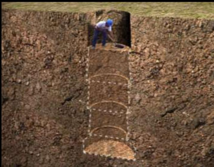
Esquema de excavación de pozos con un torno.
