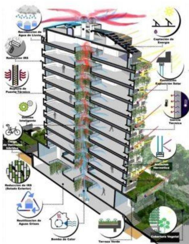
Figura 20. Estrategias combinadas de eficiencia, edificio MAASP, Gob. Prov. Córdoba.
