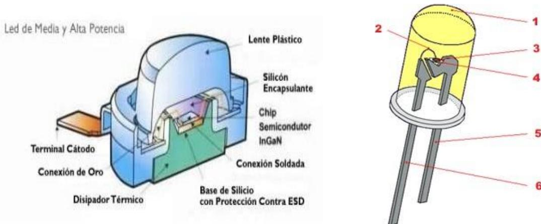
1. **Lente Epóxido** Este lente mantiene todo el paquete estructurado, determina el haz de luz, protege al chip reflector, además de extraer el flujo luminoso.
