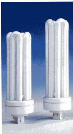
Fig. 5.81 Fluorescente compac- ta no integrada PL, Blax Q-E de GE Lighting, 2004. Con 5 temperaturas de color, entre 2.700 y 5.000 °K. 57 o 75 W regulables con balasto electróni- co. 74 lm/W, IRC 82.
