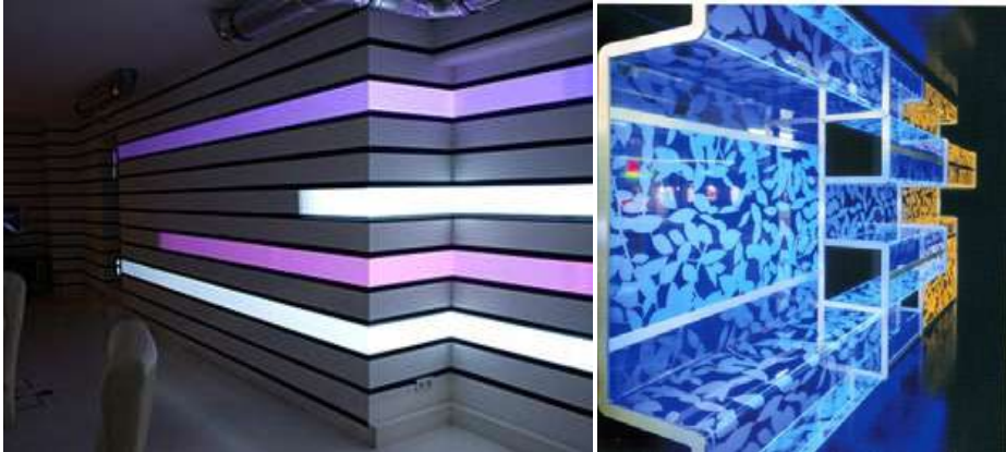
Fig. 5.88 Algunas luminarias de oleds. Oled utilizado como material de revesti- miento de una pared, como si fuera cerámica luminosa.
