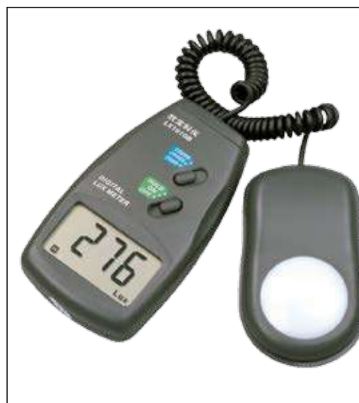
Luxómetro: dispositivo para medir el nivel de lx
