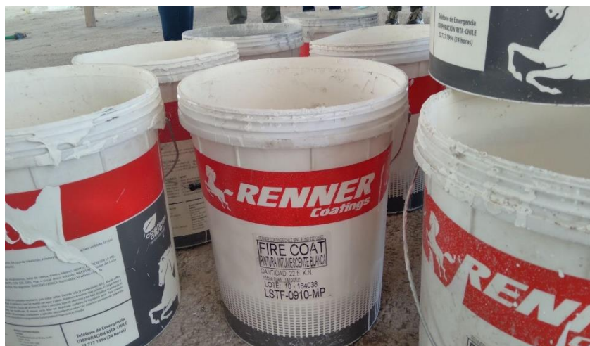
Pinturas intumescente usada en obra.
