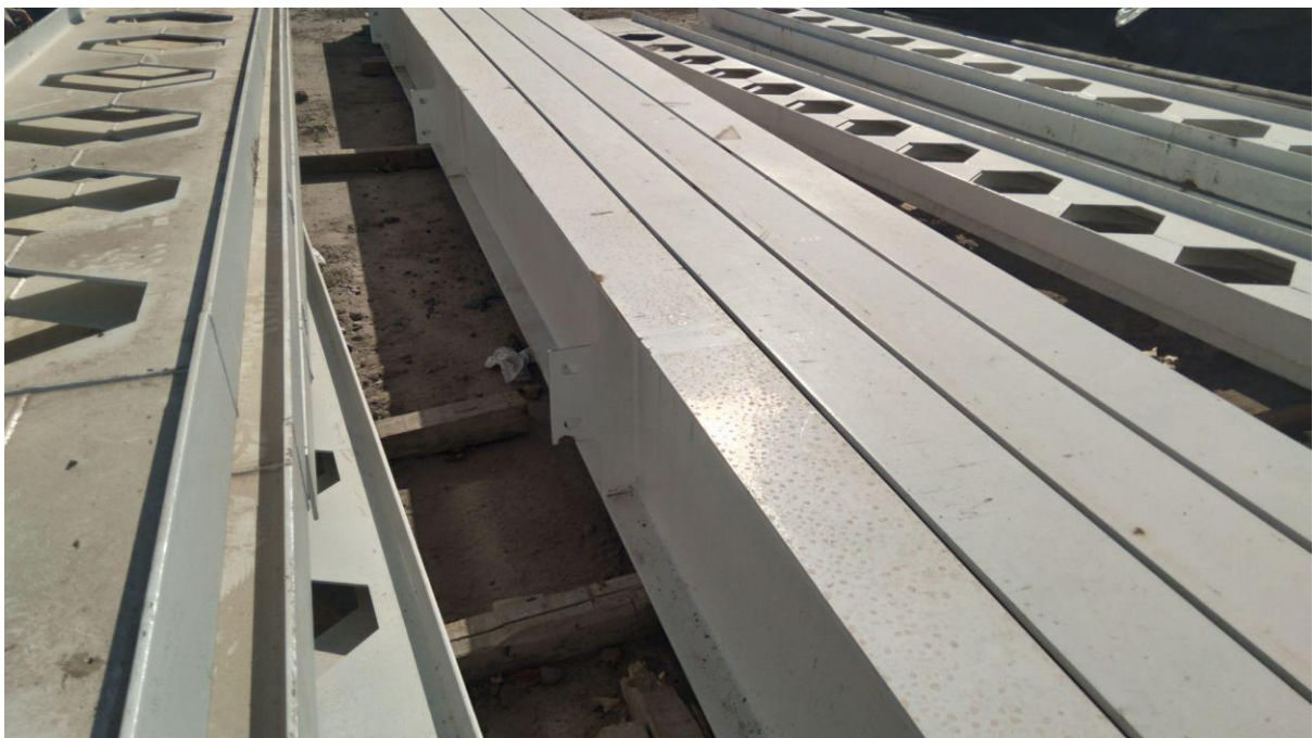
Vigas alveolares con perforaciones hexagonales
